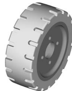
Artikel- Nr.: 141 346 Abmessungen [mm]: \varnothing 233/50 \times 85 ; 4 Loch passend für Sachnr.: 58259000
