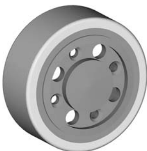
Artikel- Nr.: 141 626 Abmessungen [mm]: \phi 216 \times 79/68,3 ; 4 Loch passend für Sachnr.: 87485
