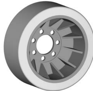
Artikel- Nr.: 141 694 Abmessungen [mm]: \varnothing 330/80 \times 135 ; 7 Loch passend für Sachnr.: 9.815.000.599 + 8418471
