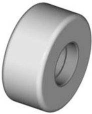
Artikel- Nr.: 140 737 Abmessungen [mm]: \phi 100 \times 45 ; LS 42x12 passend für Sachnr.: 50982 + 131005
