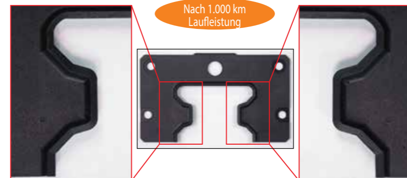
Enddichtung nicht beschädigt.
