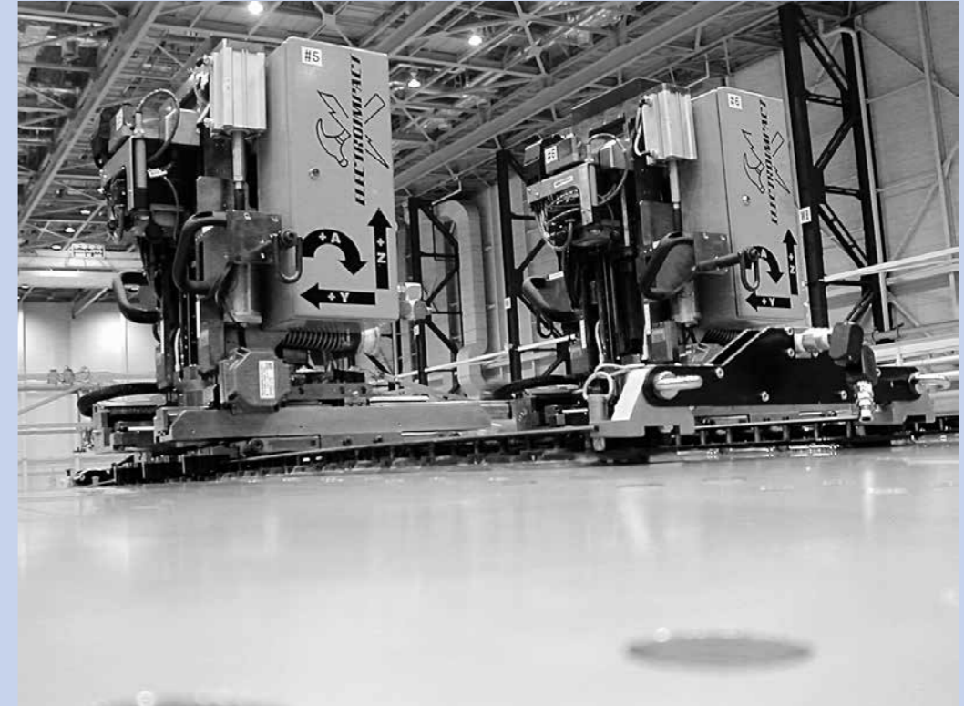
Schweißmaschine für Flugzeugumpfteile
