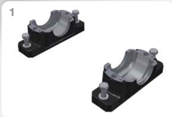
1 Unterteile der Gehäuse sicher positionieren.
